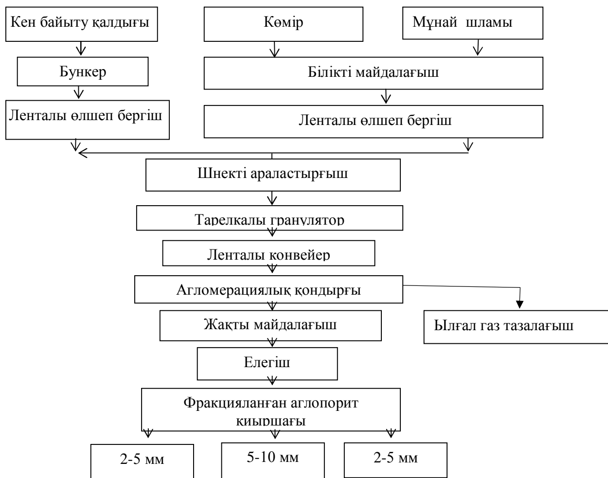
Сурет 9. Кен байыту қалдығынан аглопорит қиыршағын өндірудің технологиялық сұлбесі
